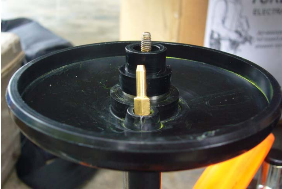
ภาพที่ 2ข ที่บังคับอัตราการไหล
