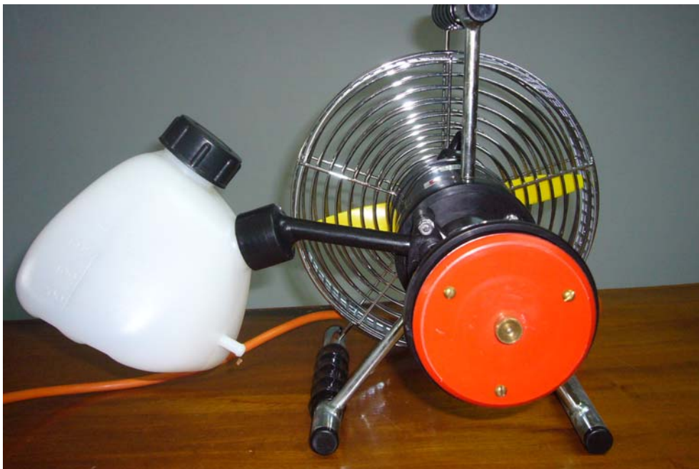
ภาพที่ 2ก เครื่องพ่นสาร CDA (Controlled Droplet Application) แบบ Air-assisted (Turbair)
