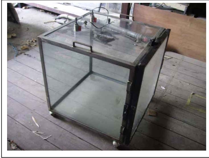
รูปภาพที่ 1 แสดงตู้ทดลองขนาด 60 x 60 x 60 เซนติเมตร สำหรับบรมสารเมทิลโบรไมด์
