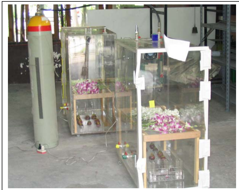
รูปภาพที่ 2 แสดงตู้ทดลองขนาด 50 x 100 x 100 เซนติเมตร สำหรับบรมสาร Eco 2 fume
