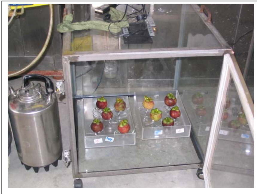
รูปภาพที่ 1 แสดงตู้ทดลองขนาด 60 x 60 x 60 เซนติเมตร สำหรับบรมสารเมธิลโบรไมด์
