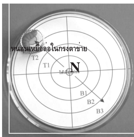
ภาพที่ 1 วิธีการทดสอบ quadrant plate bioassay (ดัดแปลงจาก Campbell, 1994)
