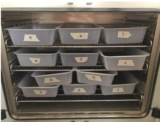
ชีวภัณฑ์อัดเม็ดเข้าสู่ตู้อบอุณหภูมิ 50 \pm 2^{\circ}\text{C}
