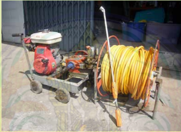
เครื่องยนต์พ่นสารแบบแรงดันน้ำสูงชนิดลากสาย
