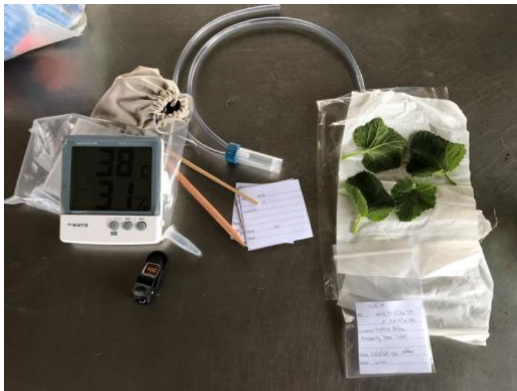
ภาพที่ 7 อุปกรณ์ในการเก็บตัวอย่างแมลงและไรศัตรูพืชและศัตรูธรรมชาติ
