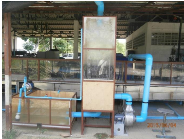
ภาพที่ 1 หอบำบัดก๊าซซัลเฟอร์ไดออกไซด์ปรับปรุงเพิ่มเติมกับเครื่องแช่ลำไย
