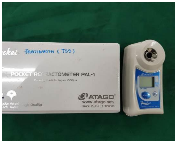
(ง) เครื่องวัดปริมาณของแข็งที่ละลายน้ำได้ (TSS)
