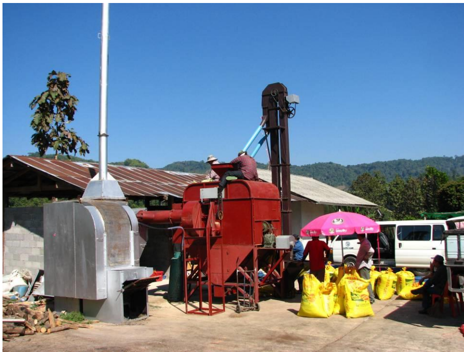
รูปที่ ๓ เตาชีวมวลทดสอบอบแห้งกับเครื่องกาแพะลาขนาด ๘๐๐ กิโลกรัม
