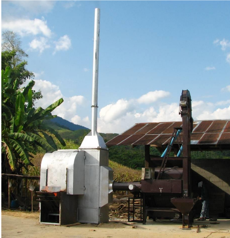
รูปที่ ๒ เตาชีวมวลทดสอบกับเครื่องอบแห้งกาแพะลาขนาด ๔๐๐ กิโลกรัม
