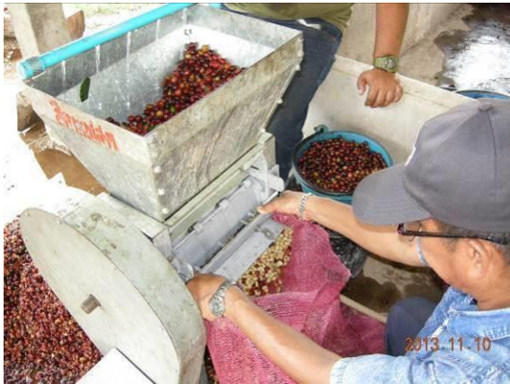
รูปที่ ๑๘ ทดสอบชุดควบคุมการลอกเปลือกแบบแผ่นยางที่กลุ่มแปรรูปกาแฟสวนยาหลวง บ้านสันเจริญ จ.น่าน
