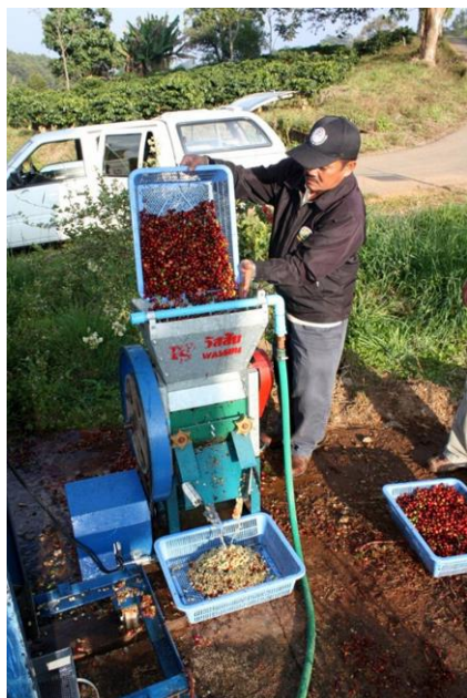
รูปที่ ๑๐ เครื่องลอกเปลือกกาแฟสด มีตะแกรงโยกคัดแยกเปลือกและผลกาแฟที่ลอกเปลือกไม่สมบูรณ์ (ขวา)
