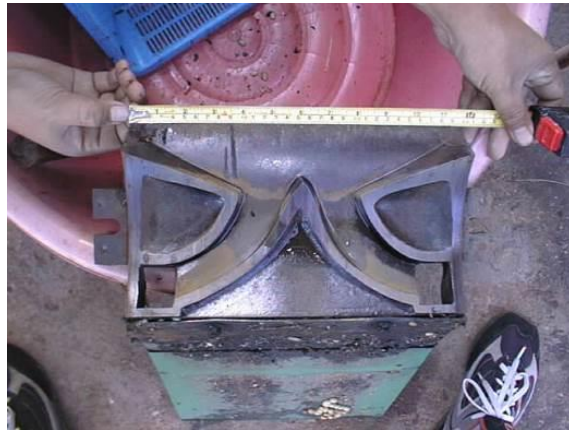
รูปที่ ๙ เครื่องลอกเปลือกกาแฟผลสด แบบมีส่วนปรับการสีและส่วนปรับการแยกเปลือกเป็นชิ้นเดียวกัน
