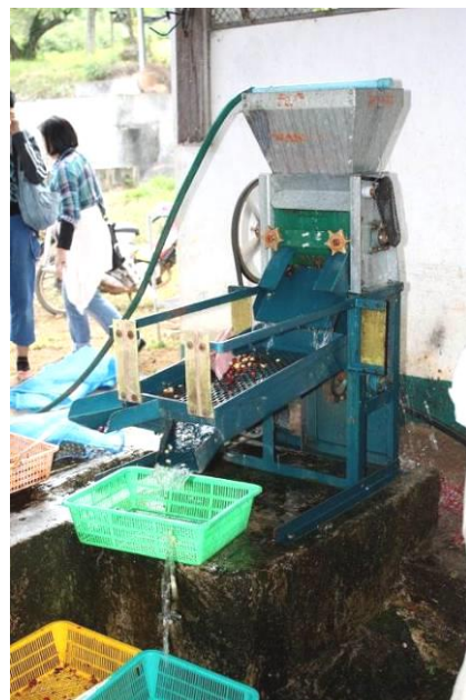
รูปที่ ๑๐ เครื่องลอกเปลือกกาแฟสด มีตะแกรงโยกคัดแยกเปลือกและผลกาแฟที่ลอกเปลือกไม่สมบูรณ์ (ขวา)
