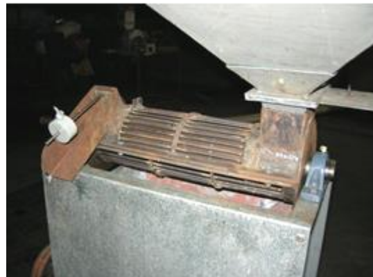
รูปที่ ๑๔ ต้นแบบเครื่องลอกเปลือกกาแพผลสดแบบแกนทรงกระบอกแนวนอนติดรีว
