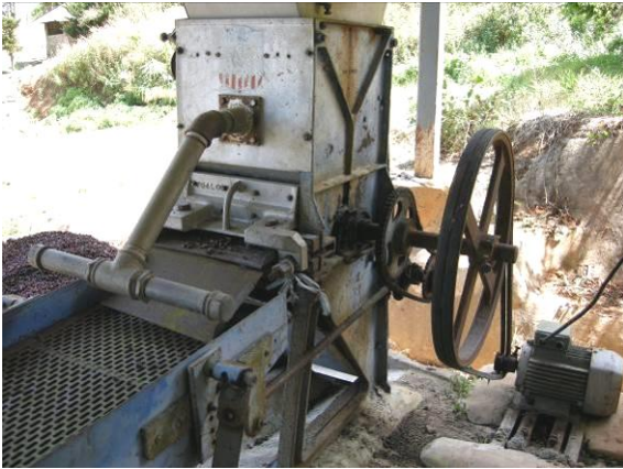
รูปที่ ๑๒ เครื่องลอกเปลือกกาแฟผลสด มีชุดควบคุมการลอกเปลือกแบบแผ่นยาง
