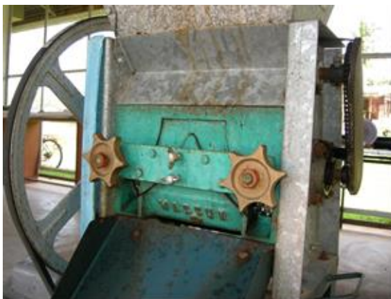
รูปที่ ๗ เครื่องสีเปลือกสดกาแฟแบบทรงกระบอกแนวนอนผลิตในประเทศไทย
