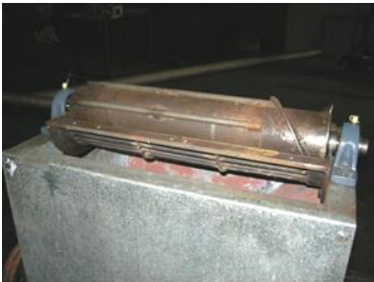
รูปที่ ๑๔ ต้นแบบเครื่องลอกเปลือกกาแพผลสดแบบแกนทรงกระบอกแนวนอนติดรีว
