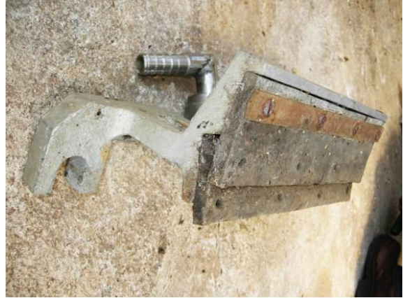
รูปที่ ๑๒ เครื่องลอกเปลือกกาแฟผลสด มีชุดควบคุมการลอกเปลือกแบบแผ่นยาง
