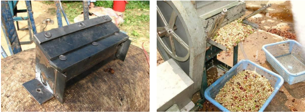
รูปที่ ๑๗ ทดสอบชุดควบคุมการลอกเปลือกแบบแผ่นยางที่ศูนย์วิจัยและพัฒนาการเกษตรที่สูงเชียงราย
