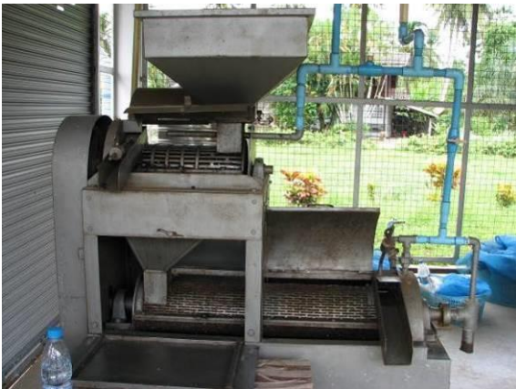
รูปที่ ๑๓ เครื่องลอกเปลือกและขัดเมือกกาแฟ (Le Trung Chau) และผลผลิตที่ได้จากการสีกาแฟโรบัสต้า
