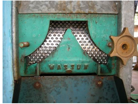
รูปที่ ๘ เครื่องลอกเปลือกกาแฟผลสด แบบมีส่วนปรับการสีและส่วนปรับการแยกเปลือกแยกกัน
