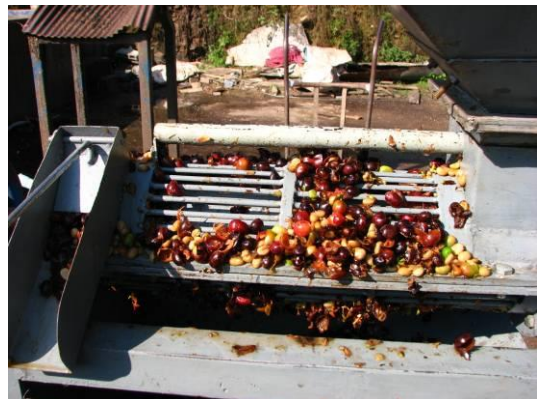
รูปที่ ๑๕ ต้นแบบเครื่องลอกเปลือกกาแพผลสดแบบแกนทรงกระบอกแนวนอนติดรีวพร้อมตะแกรงโยก
