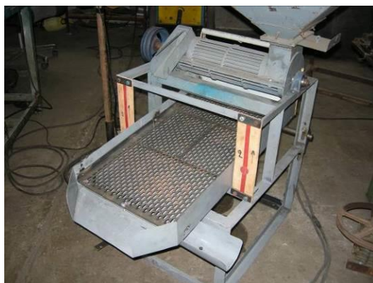
รูปที่ ๑๕ ต้นแบบเครื่องลอกเปลือกกาแพผลสดแบบแกนทรงกระบอกแนวนอนติดรีวพร้อมตะแกรงโยก
