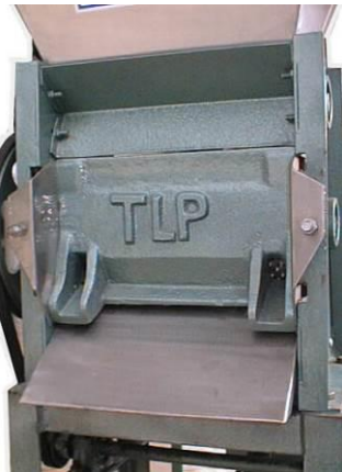
รูปที่ ๙ เครื่องลอกเปลือกกาแฟผลสด แบบมีส่วนปรับการสีและส่วนปรับการแยกเปลือกเป็นชิ้นเดียวกัน
