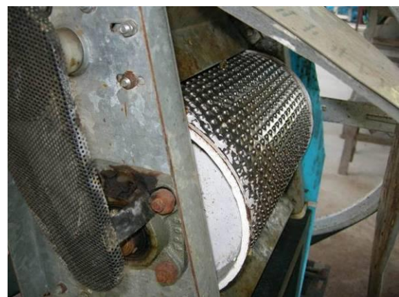
รูปที่ ๗ เครื่องสีเปลือกสดกาแฟแบบทรงกระบอกแนวนอนผลิตในประเทศไทย
