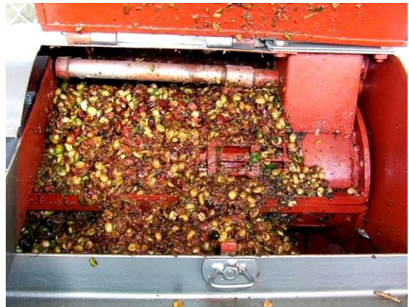
รูปที่ ๑๓ เครื่องลอกเปลือกและขัดเมือกกาแฟ (Le Trung Chau) และผลผลิตที่ได้จากการสีกาแฟโรบัสต้า
