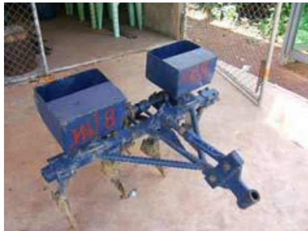
รูปที่ ๒ เครื่องหยอดสำหรับติดพวงทำรถไถเดินตาม
