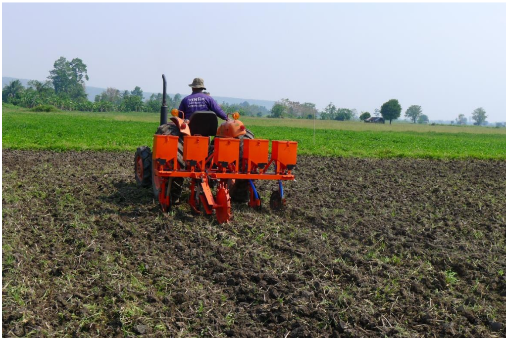
รูปที่ ๒๕ การทดสอบหยอดถั่วเหลืองฝักสดโดยเครื่องหยอดเมล็ดพืชหลังนา
