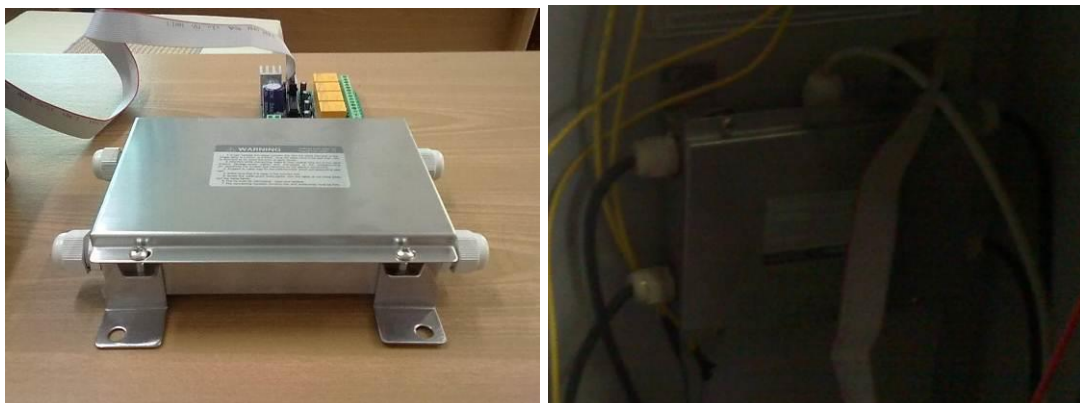
รูปที่ ๙ กล่องรวมสัญญาณจาก Load cell ทั้งที่ ๔ ตัวจากการชั่ง
