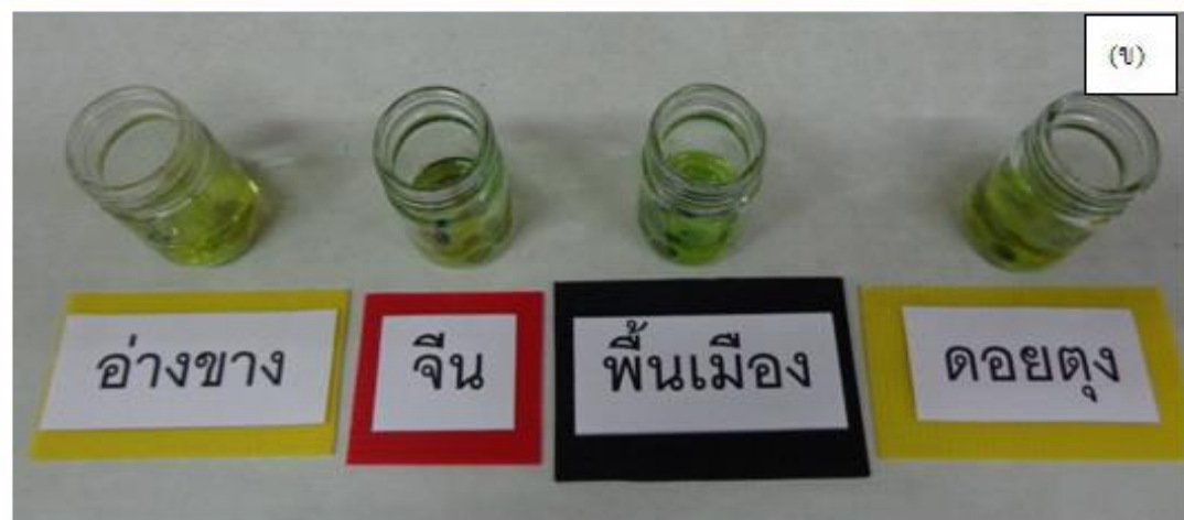
รูปที่ 6 ความเข้มสีของสารละลายก่อน (ก) และ หลังสกัด (ข) ปริมาณคลอโรฟิลล์ในใบปัญจชั้น 4 พันธุ์เมื่อสกัดด้วย acetone 85 %
