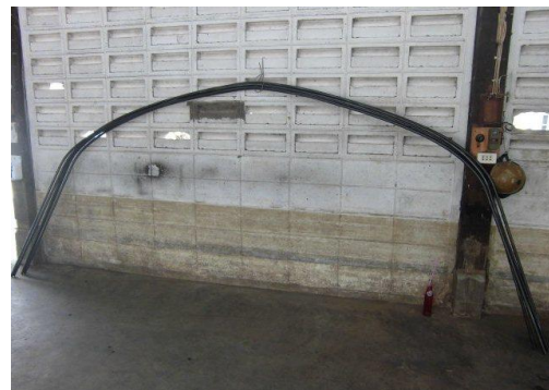
รูปที่ ๑๐ โครงท่อเหล็กที่ได้จะมีขาเฉียงเนื่องจากการติดคันท่อของเมื่อแกะออกจากแม่แบบ
