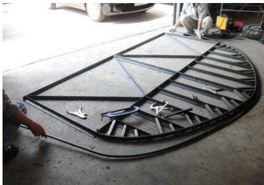
รูปที่ ๙ เมื่อตัดท่อเสร็จให้ถอดออกจากแม่แบบได้ทันที
