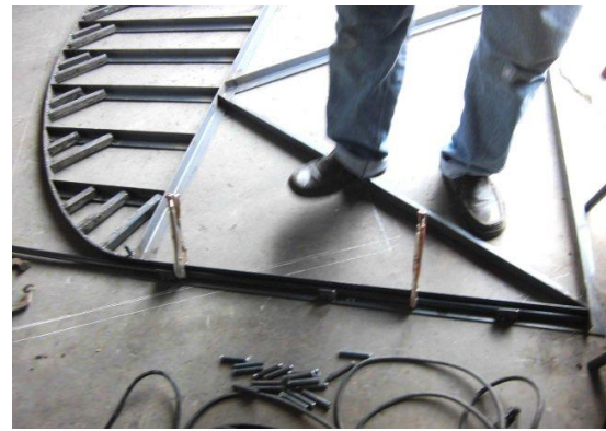
รูปที่ ๔ นำท่อเหล็ก ๑/๒ นิ้ว ใส่ช่องด้านข้าง (ซ้าย) ของแม่แบบ
