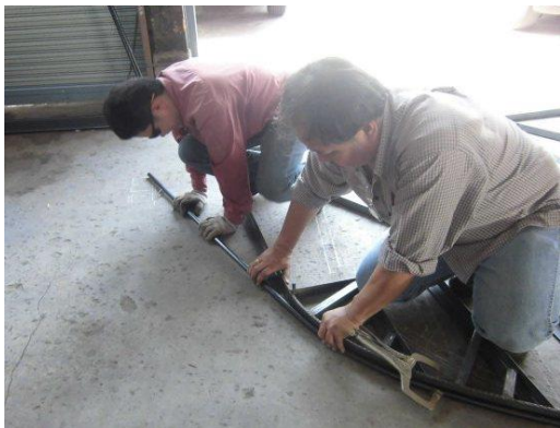
รูปที่ ๗ ตัดเหล็กและล็อกให้แนบกับแม่แบบไปจนสุดปลายท่อ
