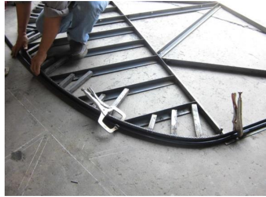
รูปที่ ๖ ช่วงที่ติดท่อเหล็กแนบกับแม่แบบแล้ว ให้จับยึดไว้ด้วยเครื่องมือสำหรับล็อก
