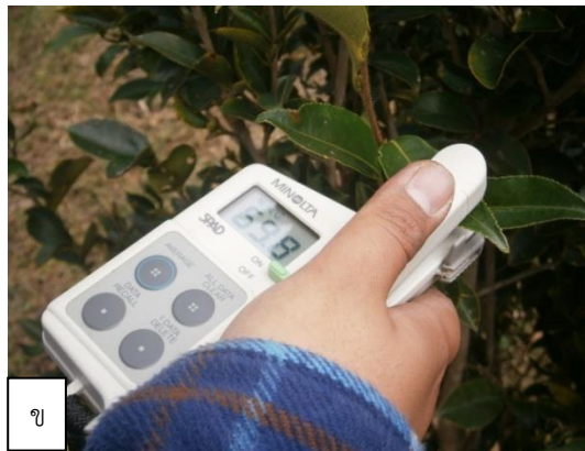
ภาพที่ ๓ การใช้ตัวหนีบก่อนวัดค่า Fv/Fm ratio (ก) และการวัดความเขียวของใบ (ข)
