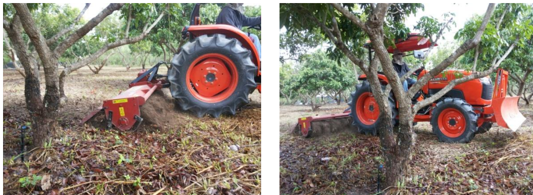
ภาพที่ ๑ การทดสอบเครื่องพรวนดินกำจัดวัชพืชในสวนลำไย
