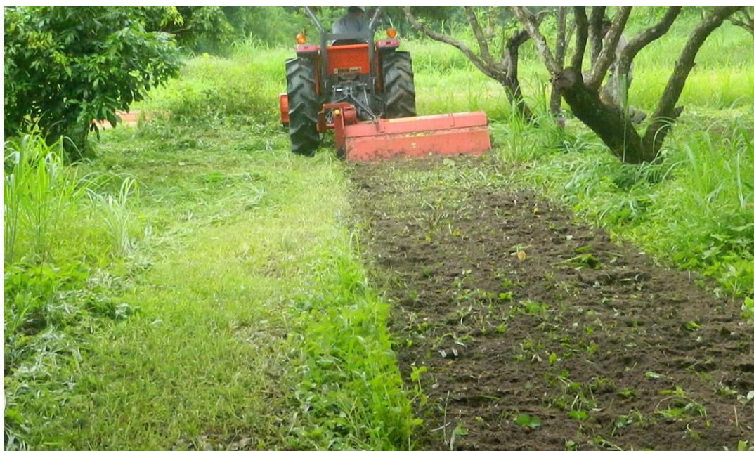
ภาพที่ ๓ ภาพวัชพืชที่ถูกกำจัดด้วยจอบหมุนเทียบกับการใช้เครื่องตัดหญ้าติดท้ายรถแทรกเตอร์
