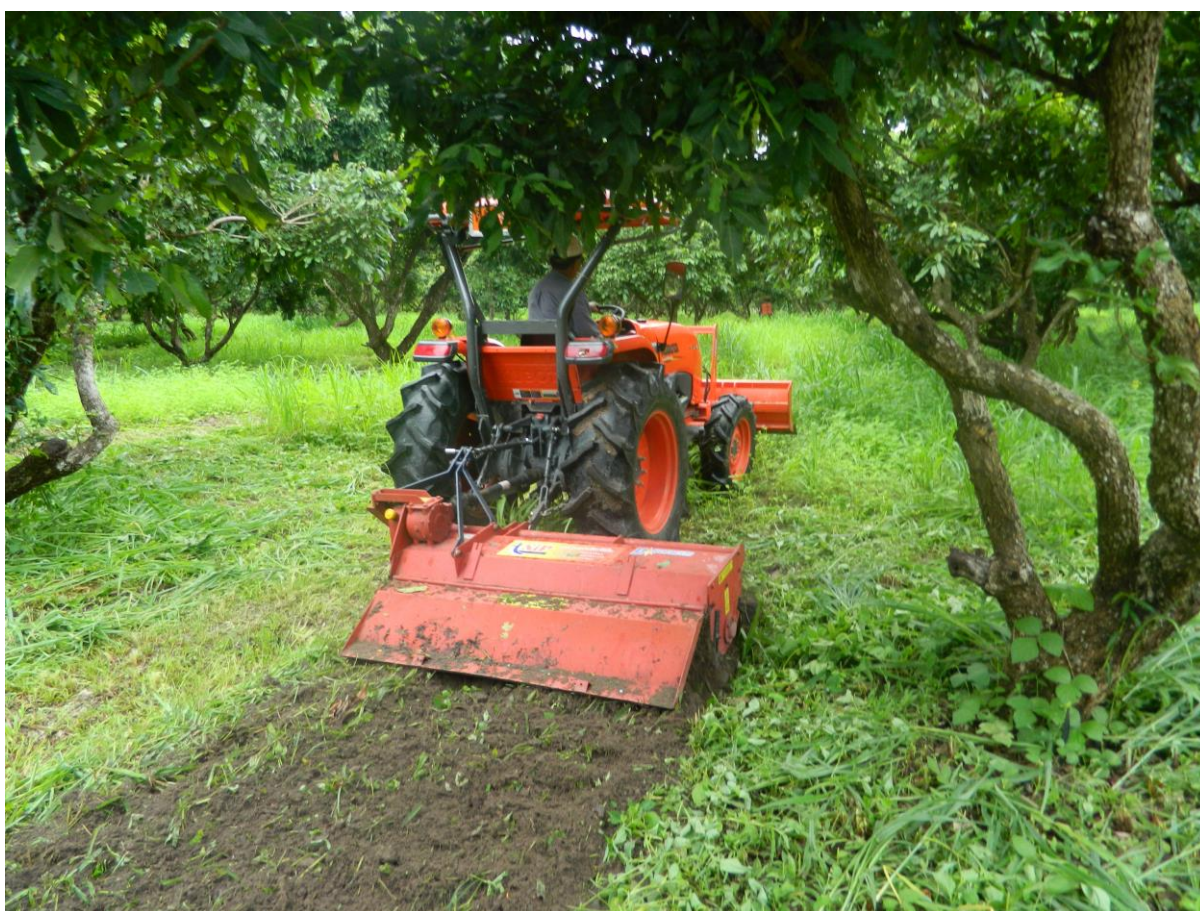
ภาพที่ ๒ รถแทรกเตอร์ขนาด ๔๐ แรงม้า ติดจอบหมุนแบบเยื้องศูนย์ทำการทดสอบในสวนลำไย
