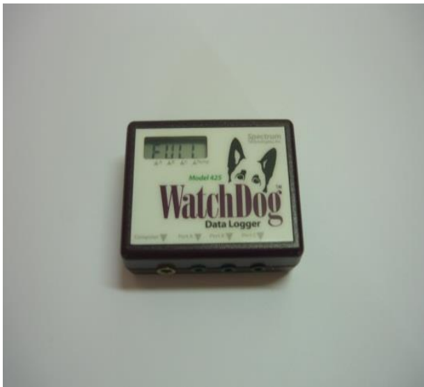
ภาพที่ ๔ Watchdog data logger พร้อมหัววัดความชื้นในดิน (Watermark Soil Moisture Sensor)
