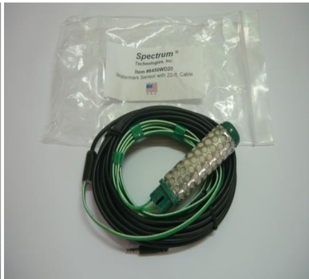
ภาพที่ ๔ Watchdog data logger พร้อมหัววัดความชื้นในดิน (Watermark Soil Moisture Sensor)
