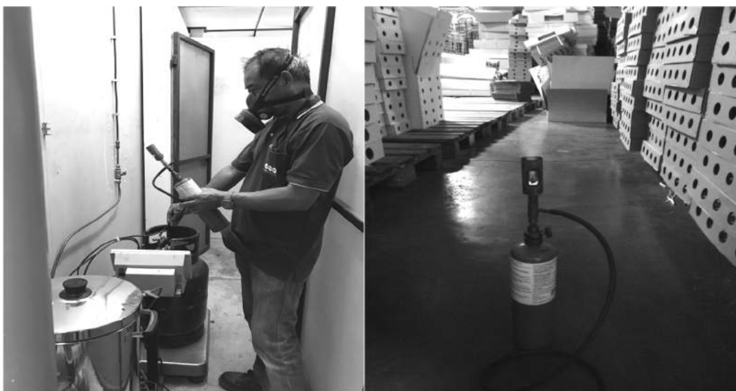
ภาพที่ 5 การตรวจการรั่วของแก๊สโดยใช้ตะเกียงฮาไลด์และสีของเปลวไฟที่มีส่วนผสมของเมทิลโบรไมด์
