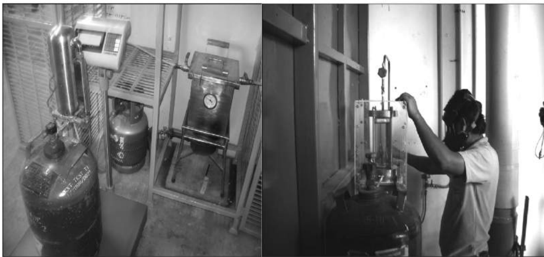
ภาพที่ 4 การจัดวางระบบปล่อยเมทิลโบรไมด์ และการปล่อยแก๊ส
