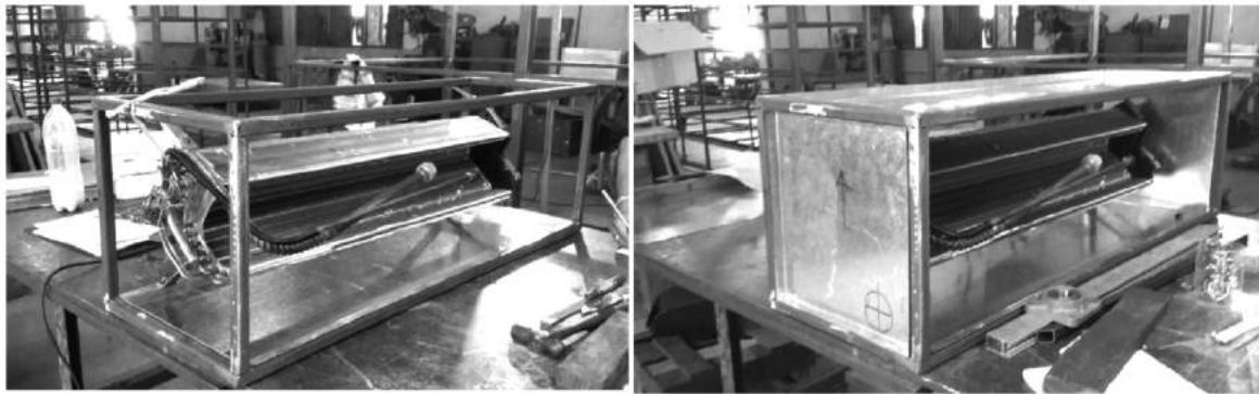
ภาพที่ 4 ติดตั้งคอยล์เย็นกับโครงสร้างกล่อง
