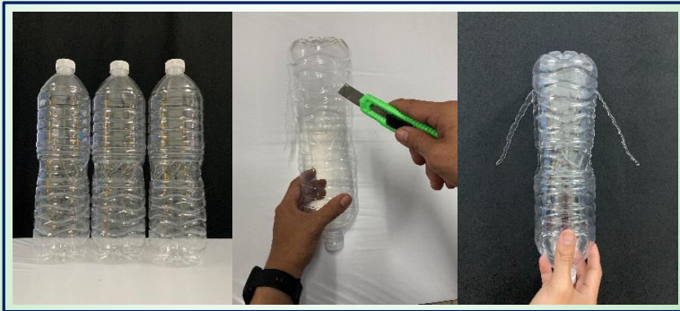
ภาพที่ 9 การเจาะช่องเปิดของขวดน้ำพลาสติก ขนาด 1.5 ลิตร
